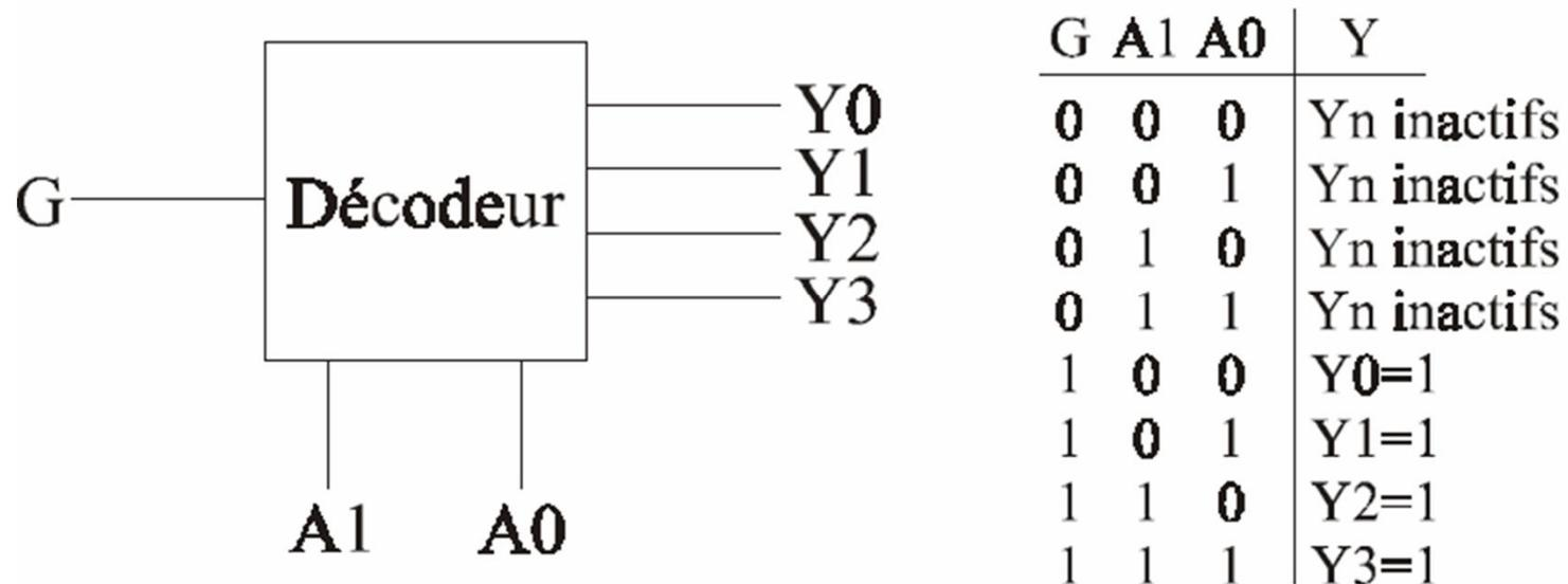
Le signal supplémentaire  $G$  (*Strobe*) est un signal d'activation du composant. Si  $G$  est inactif, toutes les sorties du Décodeur seront obligatoirement inactives.
